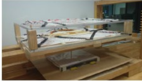
(b) Ferrite-less DD
